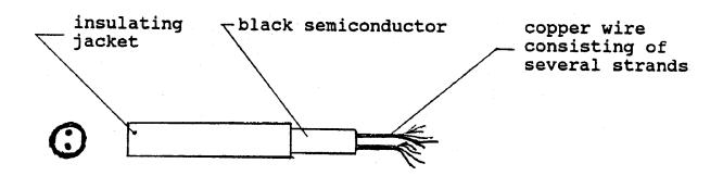
FIGURE 2 TYPICAL SELF-REGULATING HEAT TAPE (UNSHIELDED)
